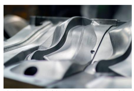
**Lohnende Strategie:** Die Nahaufnahme dieses Formeinsatzes lässt die Herausforderungen bei seiner Herstellung erahnen. Um ihn möglichst effizient fertigen zu können, ist man bei UFT zur Komplettbearbeitung mit Präzisionswerkzeugen von Mapal übergegangen © UFT
